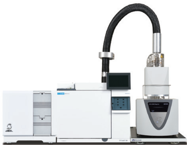
Combination of a QMS and a TG/DTA(NETZSCH)
